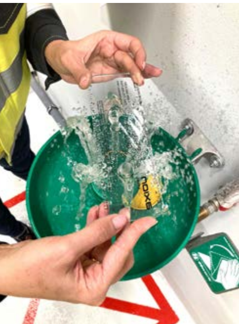
Fot. 2. Linijka do testowania prawidłowego wypływu wody w oczomyjce
